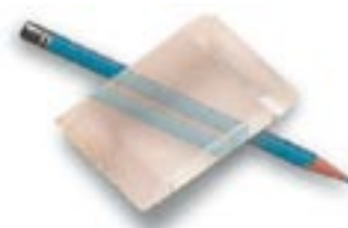
Dobbeltbrydningen ( eng birefringence) i den islandske kalkspat, har historisk set været indgangsporten til forståelsen af det mystiske polarisation af lyset.
