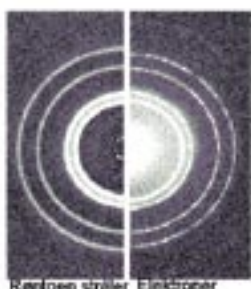
Fraunhofer diffraktion gennem en cirkulær apertur, et rundt hul.
