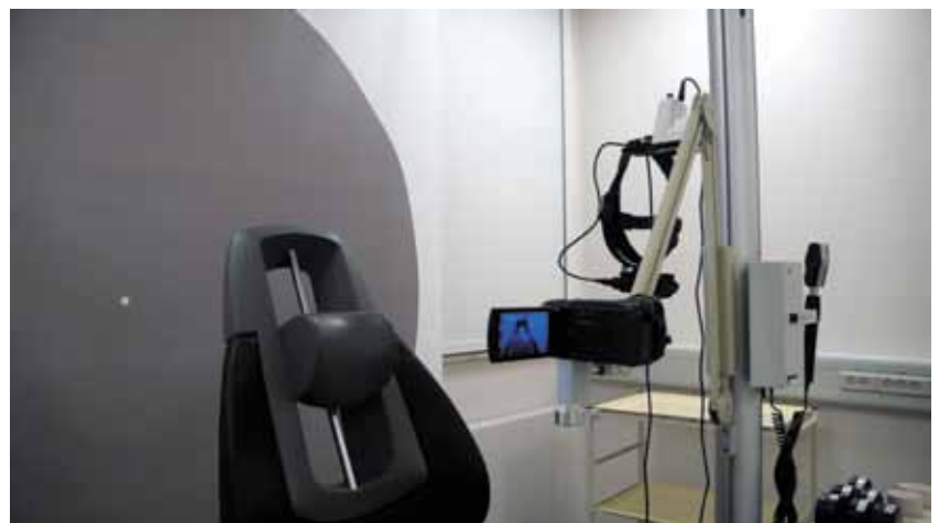
Infrarød video pupillografi til husbehov. Videokameraet (SONY HDR-XR550) er her monteret på en modificeret arkitektlampe-arm, således at man som undersøger har begge hænder fri til at foretage sine pupil- eller motilitetsundersøgelser.
