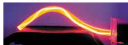
Ved den interne refleksion i lyslederen bevarer laseren sine egenskaber.
