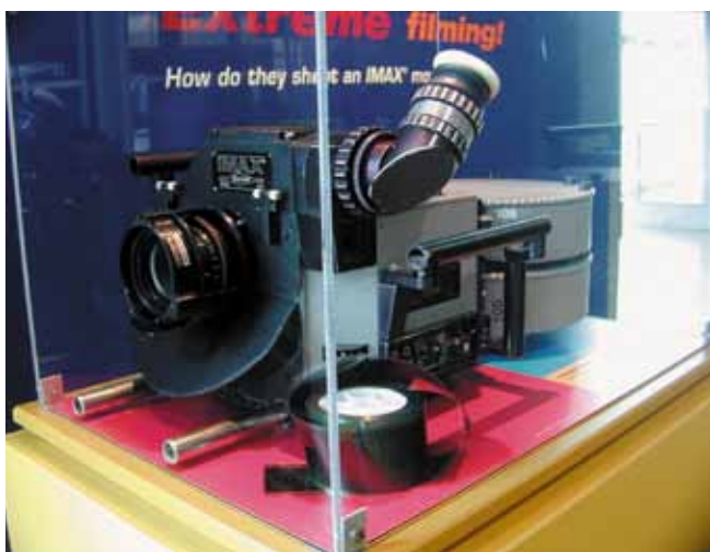
Et IMAX kamera er tungt, stort og klodset. Men skarpheden er stor, se filmbredden.
