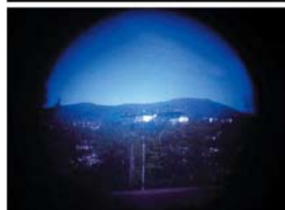
Fig.8. En optisk sylinder med diameter 2,1 mm og 6 mm lengde gir et synsfelt på ca. 35°
