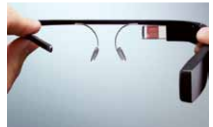
CoSoptikken består teknisk af en 'Liquid Crystal' på et Silicium (LoS) felt delt farve LED belyst skærm. Skærmens LED-belysning er først P-polariseret og lyser herefter gennem den indkoblende polariserende beam splitter (PBS) på LoS panelet. Panelet reflekterer lyset og omdanner det til S-polarisation på de aktive panelpunkter.
