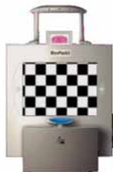
Figur 1: Monitoren som gir stimuli til brukeren. Brukeren flyttes nærmere eller lengre bort fra den etter definerte avstander i forhold til hvilken synsskarphet vi forventer å finne
